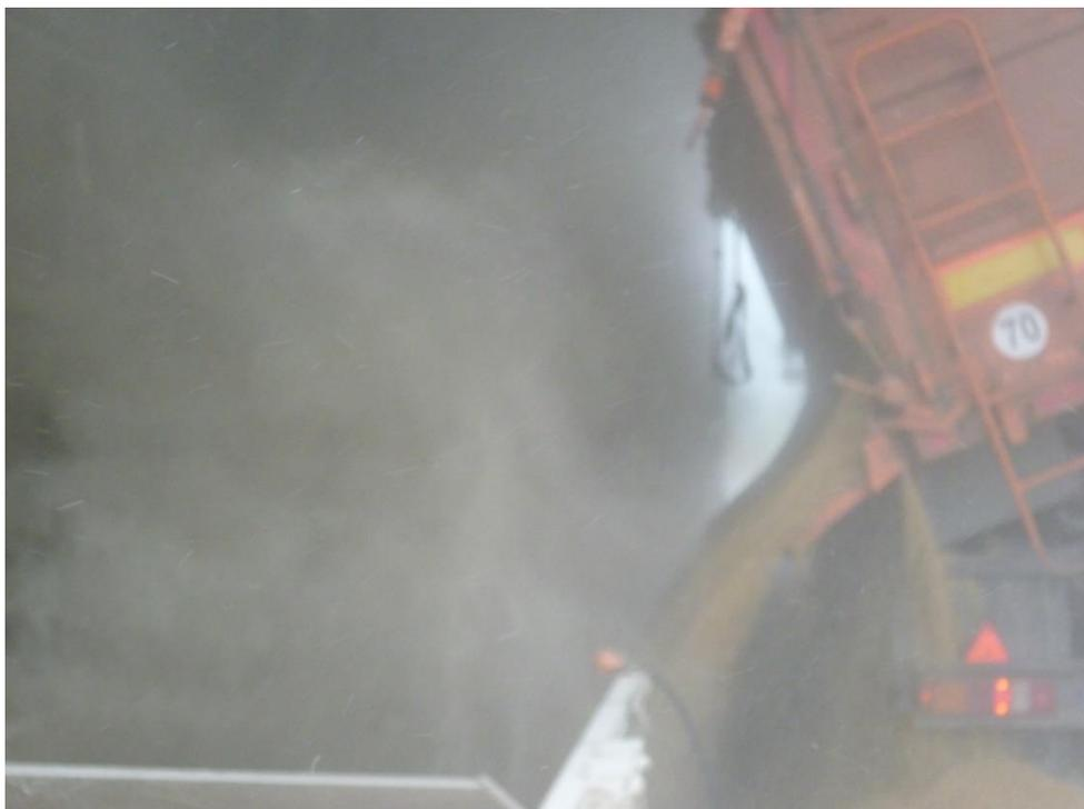
**Рис. 4.7.** Вид на выделение пыли в воздух приемного пункта со стороны рабочего места
