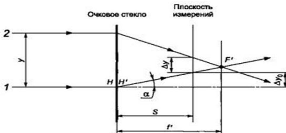
**Рис. 2.4.** Принципиальная схема дополнительного метода испытания на сферическую рефракцию и астигматизм на малых участках очковых стекол:  $u$  – расстояние между параллельными световыми лучами 1 и 2, мм;  $f'$  – заднее фокусное расстояние очкового стекла, м;  $\Delta y_0$  – линейное отклонение осевого луча 1 в плоскости измерения, мм;  $\alpha$  – угол отклонения осевого луча 1;  $\Delta y$  – расстояние между точками пересечения преломленных лучей 1 и 2 с плоскостью измерения, мм
